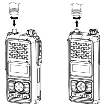
Figur 5-1) Antenne installasjon og fjerning
